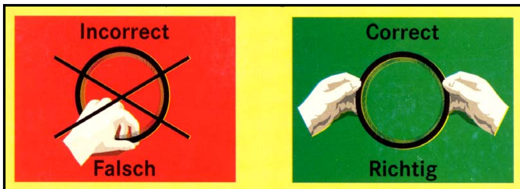
Bild 1 - Handling der MTU Bürstendichtung
