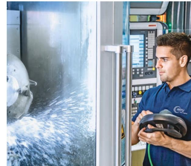
Die MTU hat nicht nur das PECM-Verfahren zur Herstellung von Nickel-Blisks entwickelt – sondern auch die Maschinen, die in München im Einsatz sind.
