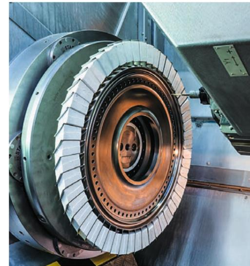
Hightech-Fertigung: Bearbeitung einer Blisk für den Mitteldruckverdichter des TP400-D6 mittels einer 5-Achs-Fräsmaschine.
