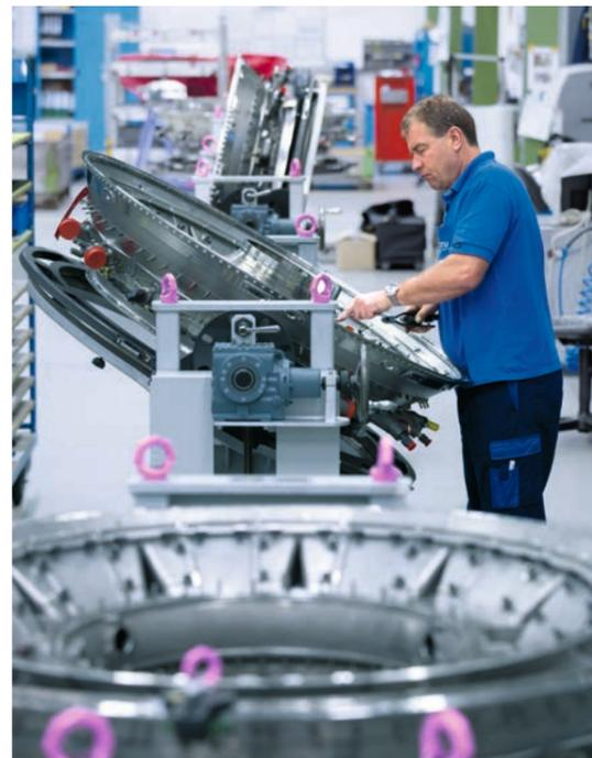
GTF Triebwerksfamilie: Die schnelllaufende Niederdruckturbinen der MTU wird mit dem Kerntriebwerk verbunden.
