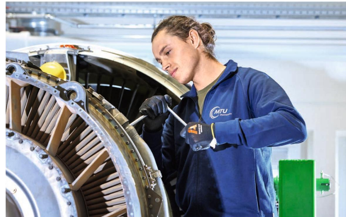
Montage eines CFM56-7 Triebwerks: Mit ihren Verfahren erzielt die MTU Maintenance weltweit einzigartige Reparaturtiefen und lange Triebwerkslaufzeiten am Flügel.
