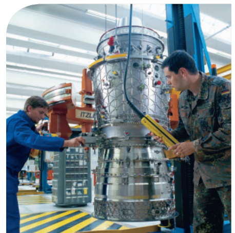
Mitarbeiter der MTU und der Bundeswehr montieren im Rahmen des kooperativen Modells gemeinsam das Eurofighter-Triebwerk EJ200.
