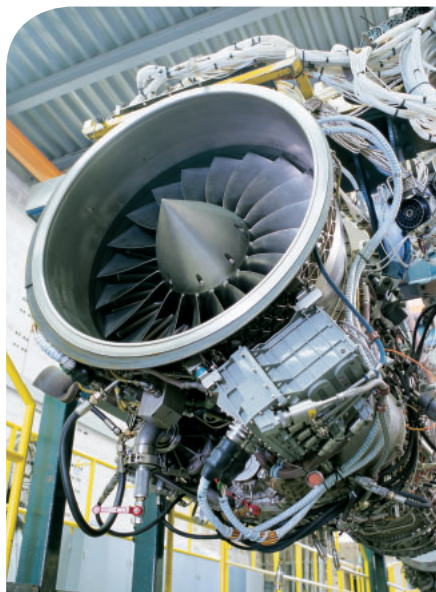
Das EJ200, Antrieb für den Eurofighter, gilt als modernstes Triebwerk seiner Klasse.
