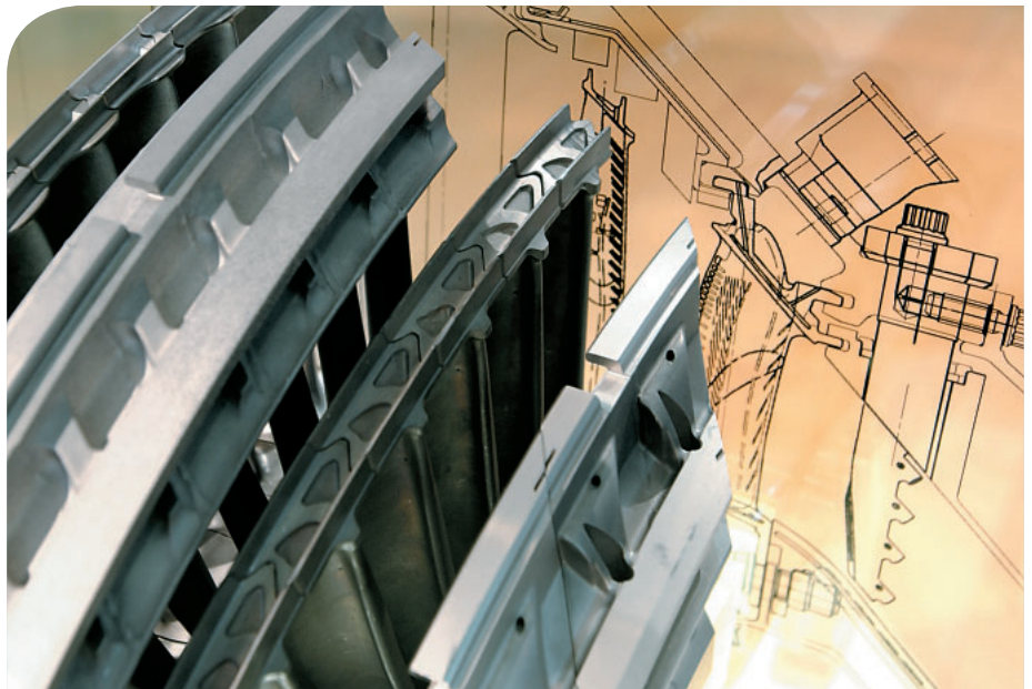
Antrieb der Zukunft: der Advanced Technology Fan Integrator (ATFI) – hier ein Segment der schnelllaufenden Niederdruckturbinen- .
