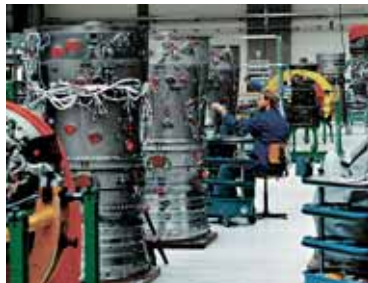
Das Tornado-Triebwerk RB199 wird für die Luftwaffe bei der MTU München montiert
