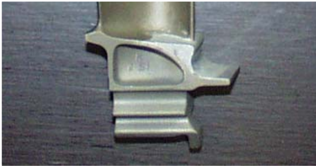
BILD 10: Modifikationen im Nabenbereich der Laufschaufeln
