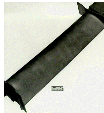
BILD 11. TiAl Turbinenlaufschauflern hergestellt durch Feinguß und endbearbeitet durch Schleifen
