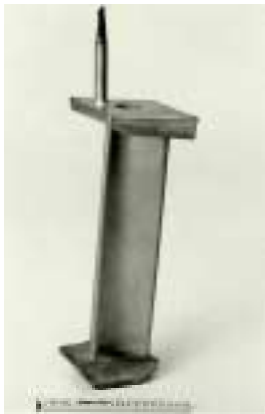
BILD 12. Pulvermetallschaufel, hergestellt durch heiß-/isostatisches Pressen in einer Stahlkapsel
