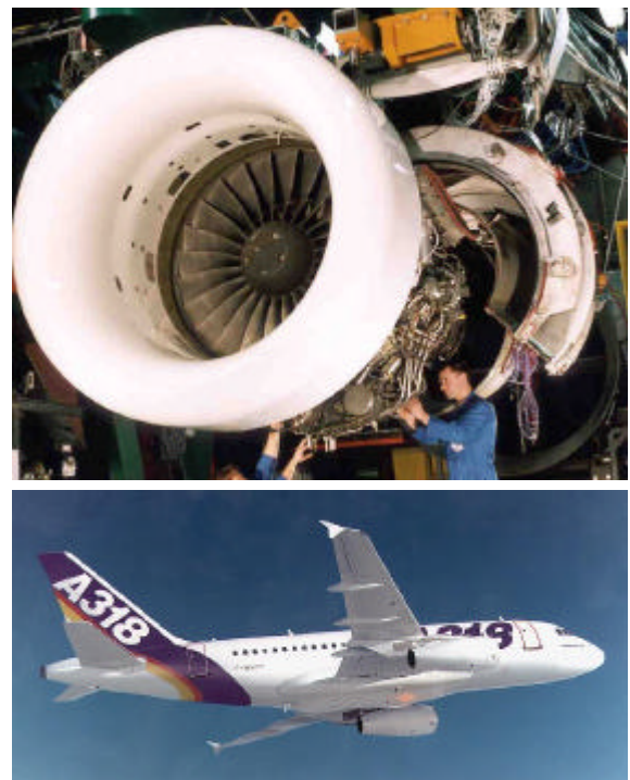
BILD 16: HDV12 Hochdruckverdichter im PW6000 Triebwerk auf dem Prüfstand und die geplante A318 Anwendung
