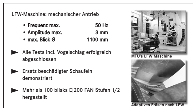
Bild 14: Blistk-Herstellung durch lineares Reibschweißen und adaptives Fräsen
