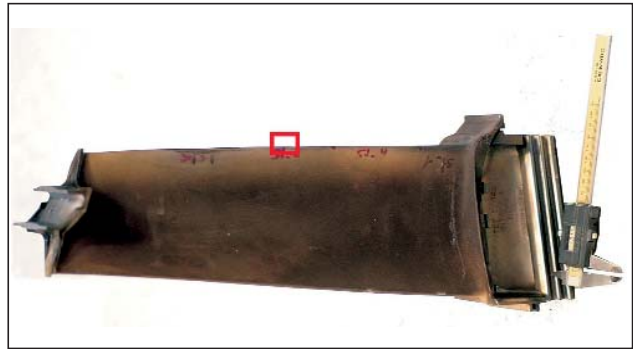
Abb.9: Gasturbinenschaufel, Markierung entspricht Prüfbereich
