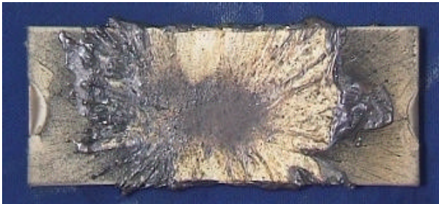
BILD 13: Titanfeuerschutz-Versuch: Die Wärmedämmschicht hat ein Durchbrennen des Verbundeinlaufbelages verhindert.
