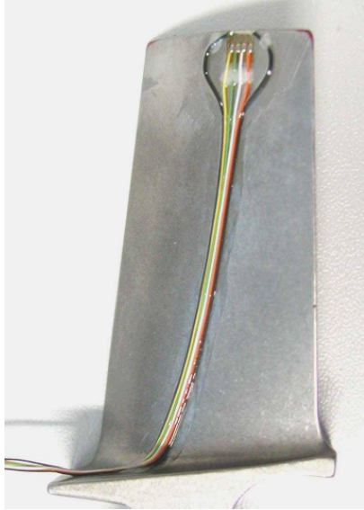
Bild 1: Mit DMS instrumentierte Turbinenschaufel
