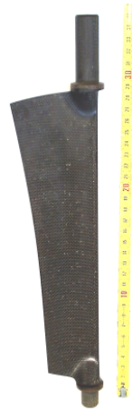
FVK Leitklappen mit Ti-Eintrittsleitstern (MTU NDV 252 Verdichter Rig) Langfaser Gestick aus Carbonfasern (Gewicht 207 g)
