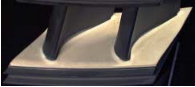
Bild 11. Turbinenleitsegment mit plasmagespritzter Wärmedämmschicht auf dem Deckband
