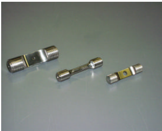
Bild 13: LCF-Prüfproben. Für die hier vorgestellten Ergebnisse wurden nur Proben mit Bohrungen (oben links bzw. rechts) verwendet.
