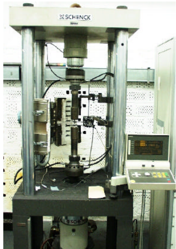
Bild 14: Prüfmaschine für die LCF-Prüfung
