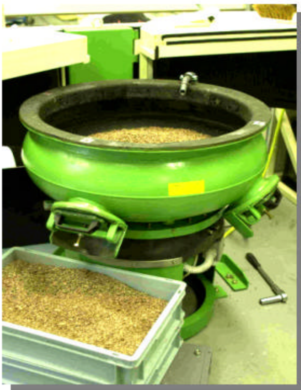
Abbildung 3: Gleitschleifanlage und gleitgeschliffene Verdichterschaufeln
