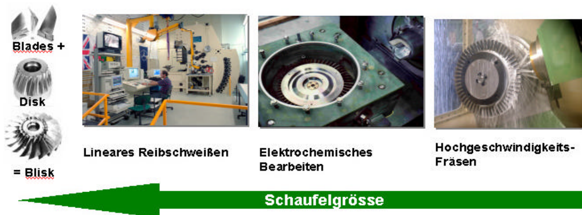
Abbildung 2: Technologien zur Bliksherstellung
