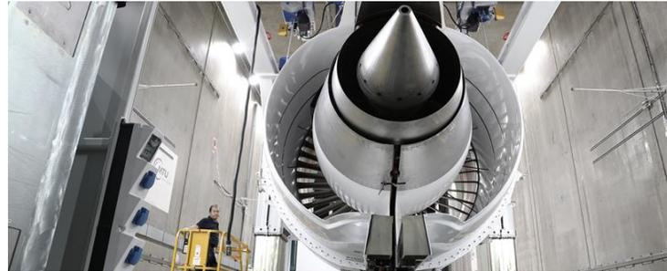
Moderner GP7000 Prüfstand
