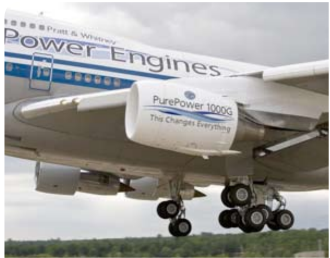
Bild: Getriebefan Demonstratortriebwerk am Flying Testbed einer Boeing 747
