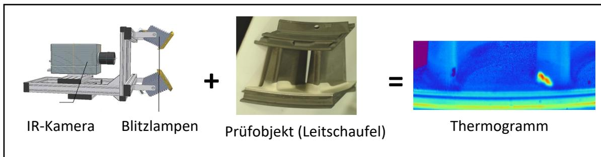
Abbildung 45: Messanordnung einer aktiven Thermografie
