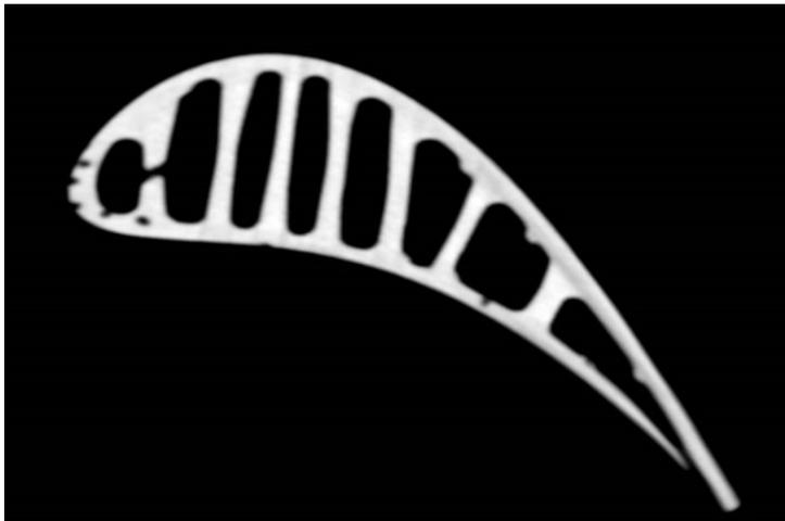
**Abbildung 86: CT-Schnitt durch eine Turbinenschaufel**
