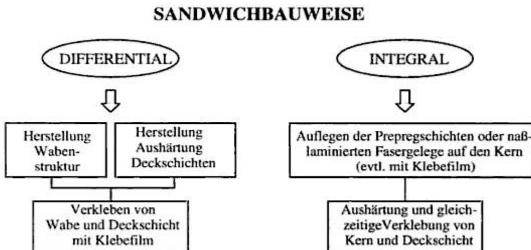
**Abbildung 10: Sandwichstruktur in Differential- und Integralbauweise [1]**
