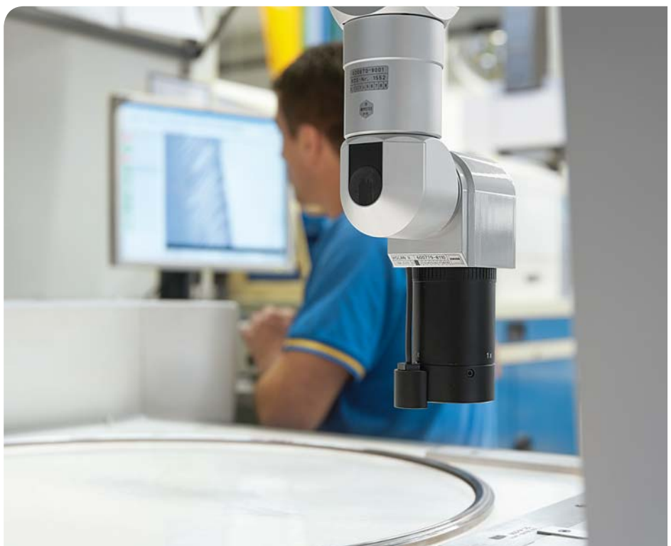
Höchste Präzision: Die Messung des Innendurchmessers erfolgt nicht taktil sondern optisch mit einer Kamera.
