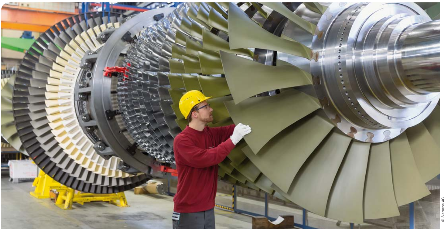
Montage einer 375-MW-Industriegasturbine.
