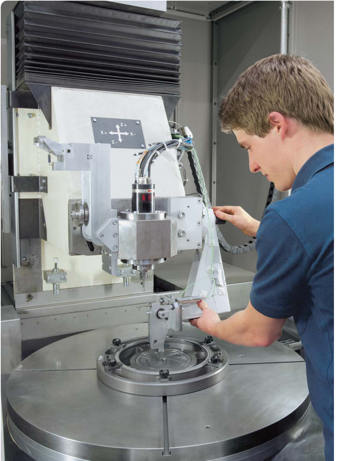
Messung der Steifigkeit einer Bürstendichtung.
