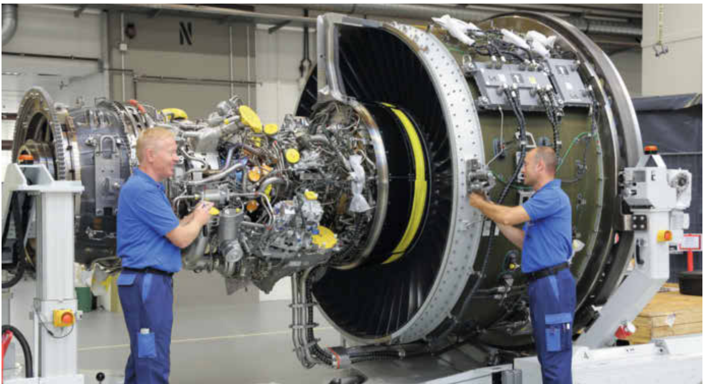
Die MTU steuert zur Pratt & Whitney GTF™ Triebwerksfamilie die schnelllaufende Niederdruckturbine und die ersten vier Stufen des Hochdruckverdichters bei.
